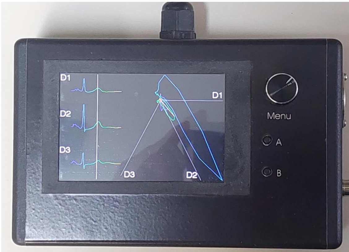
Figura 8. Vetorcardiograma mostrando o vetor elétrico do coração em todas as fases do ciclo cardíaco, e seu efeito sobre derivação I, II, e III. Este modo não usa o leitor de ondas, mas dados armazenados na memória.
