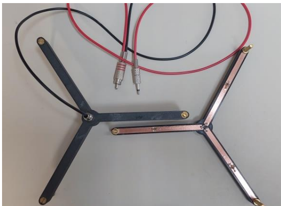
Figura 6. Terminal de Wilson. Esquerda: terminal visto do topo, conectado com o eletrodo de referência (preto). Direita: vista inferior do terminal.
